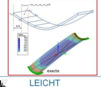
3. 2. Coques HP: comportement mécanique. Solution numérique
